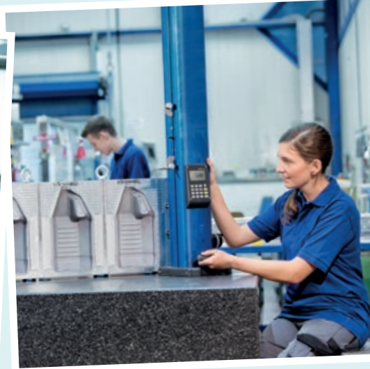
Ausmessen einer Spritzgussform
